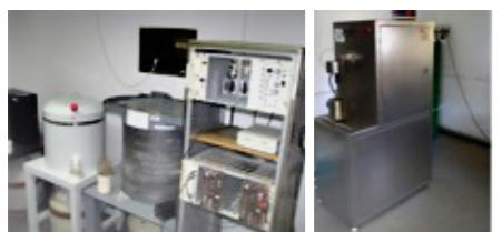
Levo: HPGe spektrometar sa prosirenim opsegom (3-3000 keV) rel. eff. 50% i HPGe spektrometar, rel. efikasnosti 30 %
